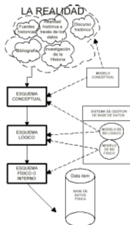
Cuadro 8. Fases del diseño de una base de datos. (según Calvo, Jiménez y Serrano)
